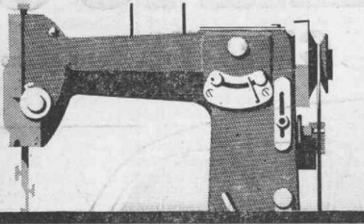
A OLIVAMÁTIC é uma máquina de tipo zig-zague universal que, além de poder trabalhar como máquina comum ou zig-zague, executa automaticamente, sem qualquer intervenção, pontos de ornato com uma ou duas agulhas e a uma ou duas cores.
