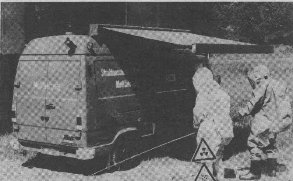
Equipamentos especiais da República Federal da Alemanha produzidos pelo grupo empresarial Krupp, de Essen, para a defesa ambiental: um barco especial para bombear produtos químicos oleaginosos de rios e lagos (acima). Um furgão para medição de irradiações para corpos de bombeiros em caso de acidentes (abaixo).
