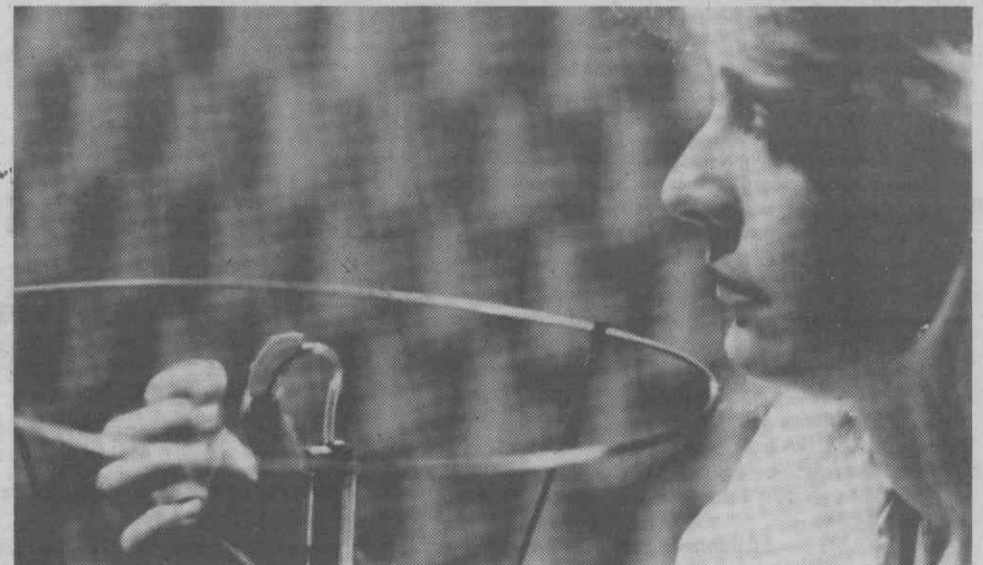
O aparelho de ouvido com graves, médios e agudos, construído pela Siemens alemã, na câmara silente para os ensaios acústicos.
