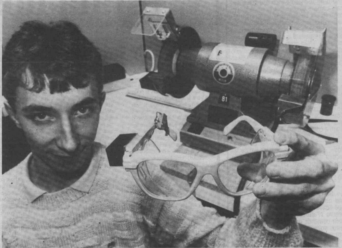
Uns óculos de grande utilidade prática foi inventado pelos escolares alemães Frank Becker (foto) e seu colega Frank Hoffmann, para o concurso «A Juventude Pesquisa», na cidade alemã ocidental de Bitburg: só depois de colocar os óculos é que a esmeriladora, perigosa pelas limalhas que produz, começa a funcionar. Antigamente trabalhava-se descuidadamente e muitas vezes sem protecção para a vista, com estas máquinas.
